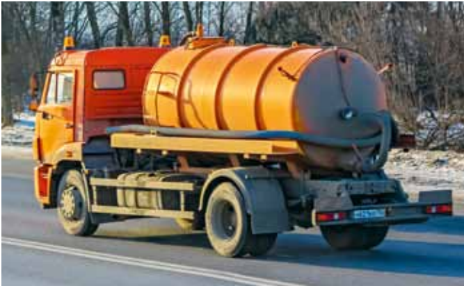
Одна из востребованных модификаций – вакуумная машина, которая всегда имеет загрузку. Вакуумная бочка используется для сбора иловых масс с накопителей автомоек, и для чистки дна колодцев
