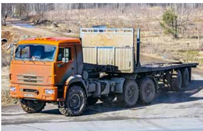
Полноприводные версии грузовиков с односкатной ошиновкой всех осей нередко используются для перевозки спецтехники или доставки элементов конструкций к различным объектам, к которым ведут плохие дороги
